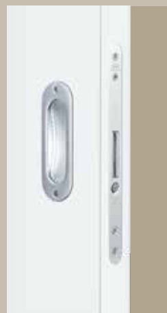
U posuvných dveří se zaskakovacím madlem můžete celé dveřní křídlo zasunout do stěny. Po stisknutí knoflíku madlo vyskočí a dveře můžete zavřít.
